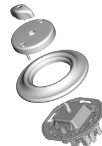
Fig. 3: Switch with rotating controls with cover and frame Abb. 3: Zusammenstellung des Drehschalters mit Abdeckung und Rahmen Рис. 3: Сборка выключателя с поворотным управлением с крышкой и рамкой
