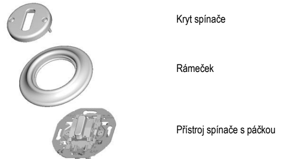
Obr. 1: Sestavování spínače s krytem a rámečkem
