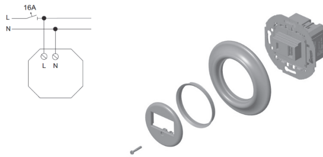
Obr. 7: Schéma zapojení a sestavování přístroje nabíjecího USB
